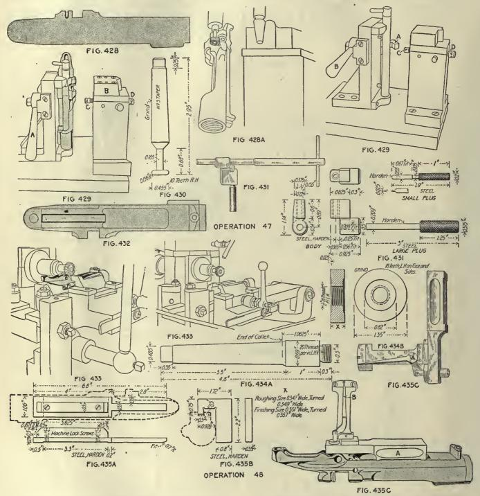
OPERATION 47. PROFILING GROOVE FOR CUTOFF-SPRING SPINDLE
