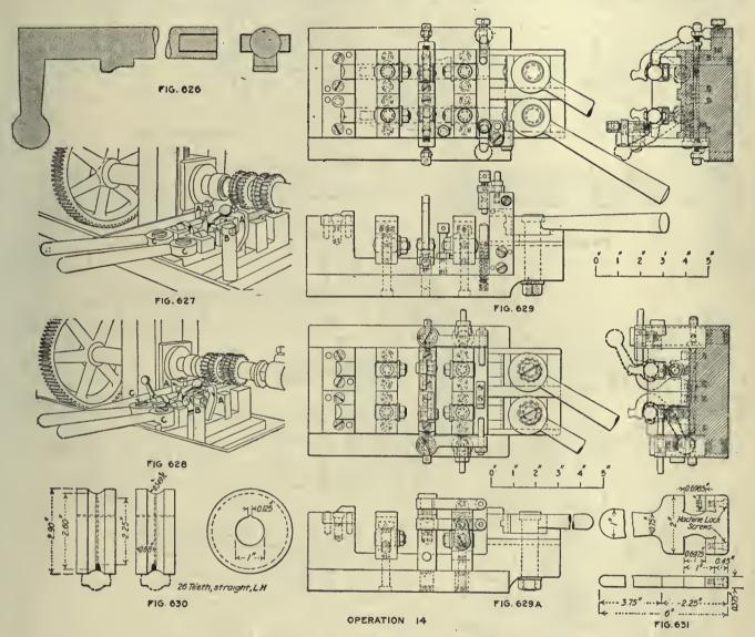
OPERATION 14. MILLING RIGHT AND LEFT SIDE OF LOCKING LUGS
