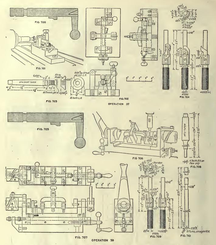
OPERATION 37. ROUGH MILLING FOR COCKING CAM
