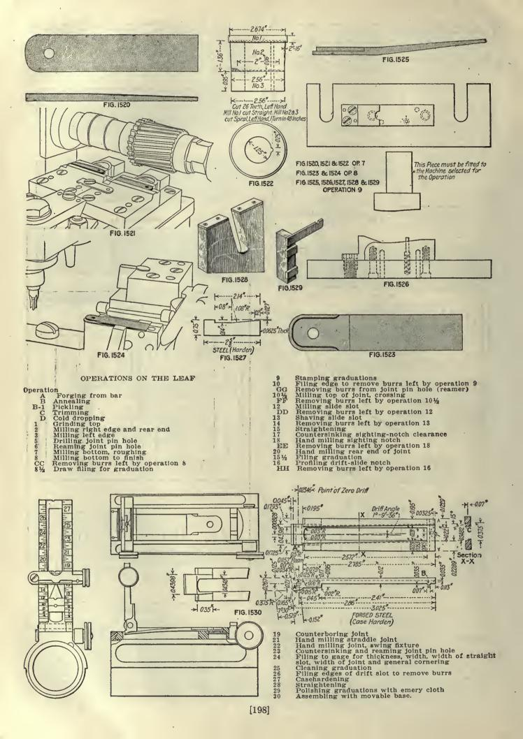
OPERATION A. FORGING FROM BAR
