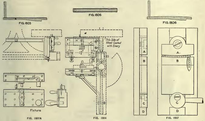
OPERATION 6. SETTING SPINDLE ON ANGLE
