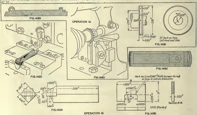
OPERATION 14. HAND MILLING REAR OF JOINT
