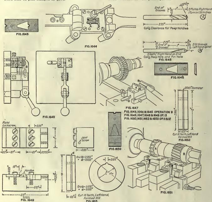
FIG. 1653 OPERATION CC. REMOVING BURRS LEFT BY OPERATION 10
