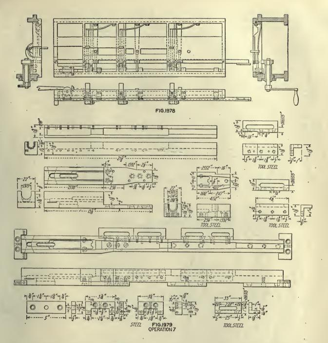
OPERATION 7. GROOVE FOR BARREL
