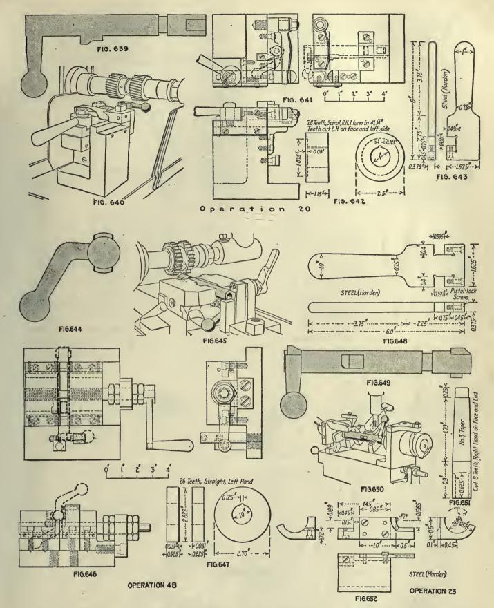
OPERATION 20. MILLING REAR OF HANDLE TO GAGE
