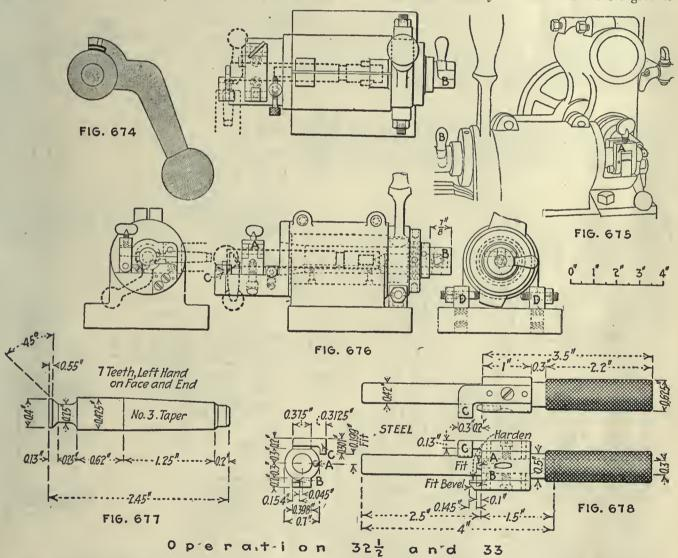
OPERATIONS 32½ AND 33. HAND MILLING FOR SLEEVE LOCK
