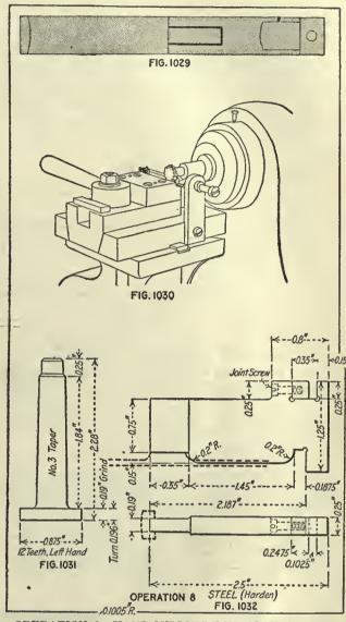
OPERATION 8. HAND-MILLING LUG SLOT, ROUGH
