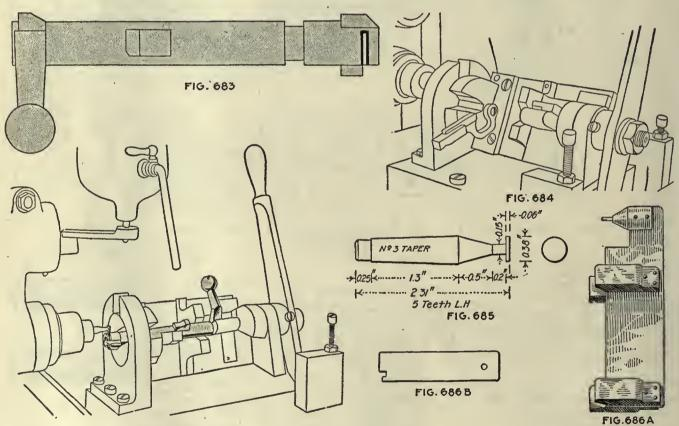
OPERATION 35. HAND MILLING FOR SLEEVE LOCK
