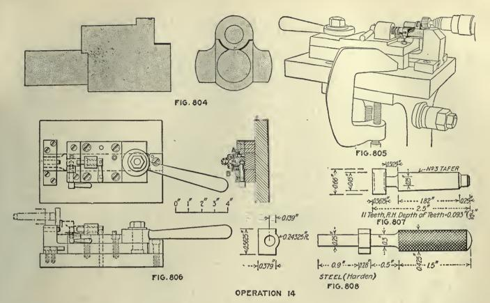
OPERATION 14. HAND-MILLING SEAT FOR SAFETY LOCK
