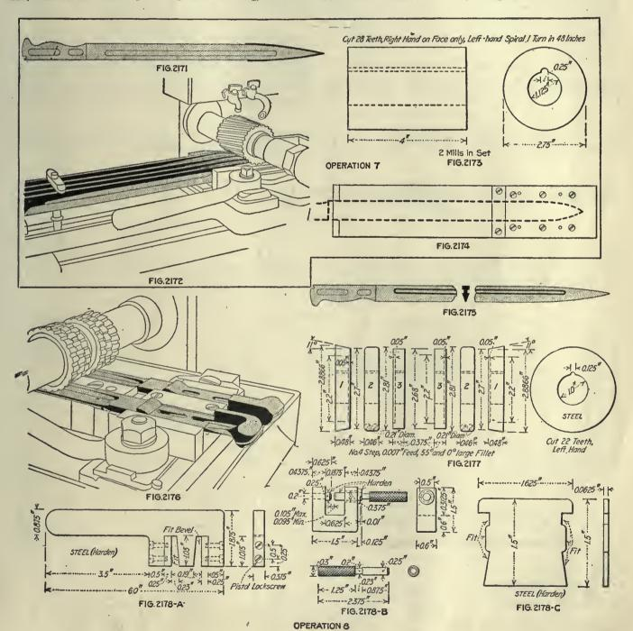
OPERATION D. TRIMMING BAYONET-CATCH SLOTS
